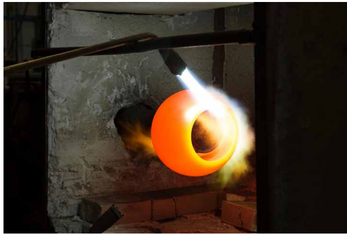
Bild 3: Prozessaufnahme des Einschmelzens einer thermisch gespritzten Kugelhahnbeschichtung mittels Acetylen-Sauerstoff-Flamme
