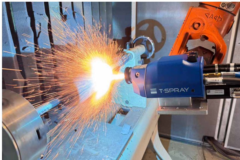
Bild 2: Der Brenner kann optional mit einem sekundären Zerstäubergas betrieben werden. Diese zusätzliche Zerstäubung beeinflusst die Spritzpartikel und den Spritzstrahl. (© T-Spray)
