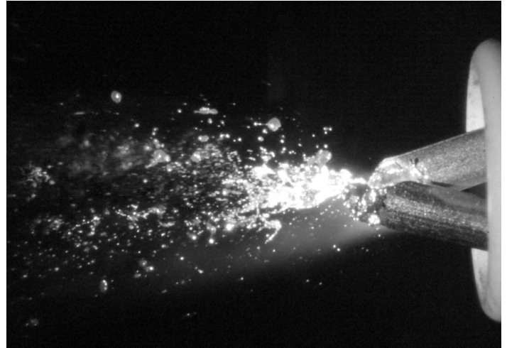
Bild 4: Hochgeschwindigkeitsaufnahme eines Prozesses mit zwei Antrieben und einem auf die unterschiedlichen Drähte angepassten Drahtvorschub; Ergebnis: ein gleichmäßiges Abschmelzverhalten der Drähte (© T-Spray)
