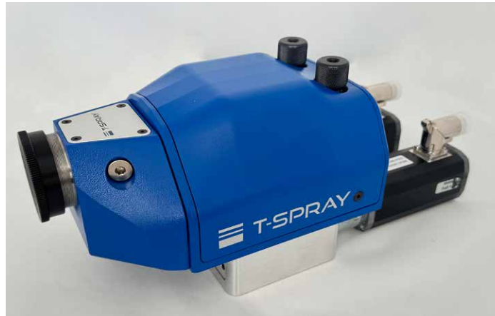
Bild 1: Bei dem zweimotorigen Maschinenbrenner kann die Drahtvorschubgeschwindigkeit der beiden Drähte einzeln eingestellt werden. (© T-Spray)
